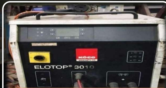
STUD WELDING MACHINE -6 NOS
